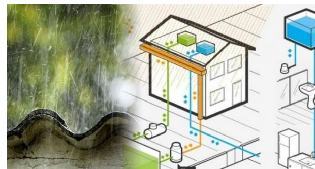
Captação de águas pluviais
